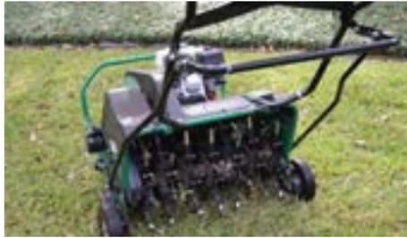
➡ Las máquinas para aireación con sacabocados son pesadas y se necesita mucha fuerza para moverlas y usarlas.
